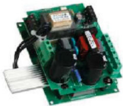
Il motore è dotato del convertitore **ACRUX AB LINK** (72 RPM) alloggiato a bordo su scatola stagna IP67. L'ACRUX AB LINK è un convertitore monofase con elettroriduttore, con funzione di teleinvertitore, comando a bassa tensione a uomo presente e rampa di accelerazione e decelerazione.
